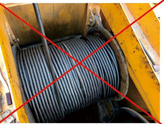
没有使用双折线绳槽皮的卷筒排缆
