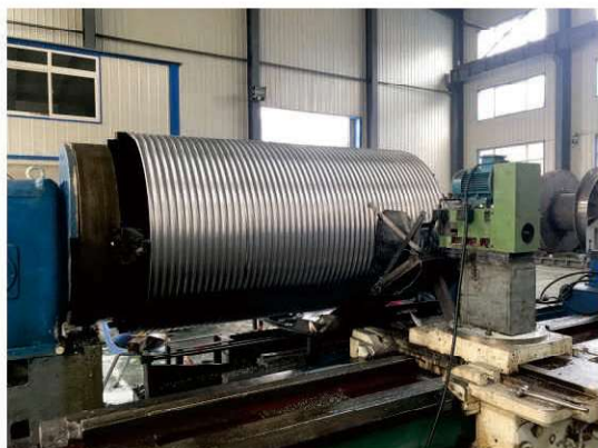
铣削绳槽 Milling rope grooves
